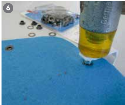
6 Coloque las argollas para los ojales.
